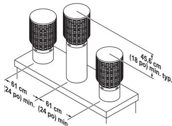
**Figure 18 - Installation avec plusieurs enchâssures**
