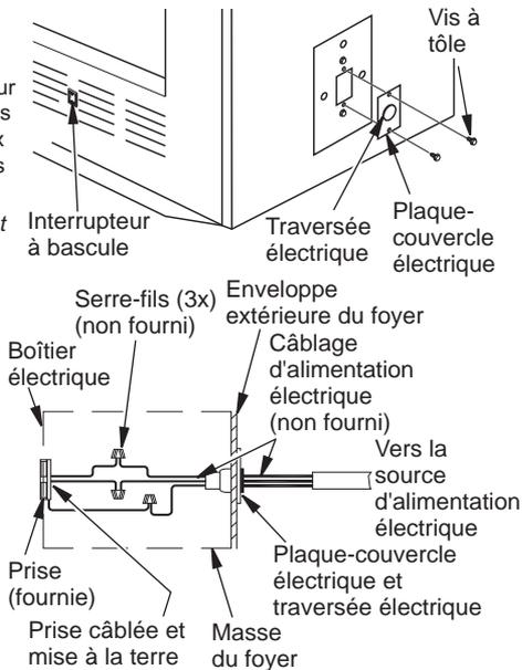
**Figure 6 - Traversée électrique d'interrupteur de ventilateur**
