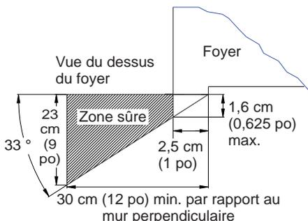
**Figure 5 - Dégradement du manteau de foyer latéral**
