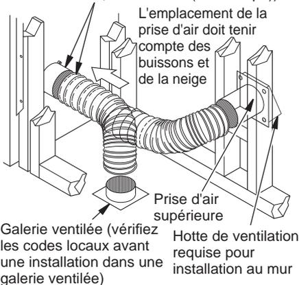
**Figure 7 - Prêt-à-monter de gaine d'air extérieur**
