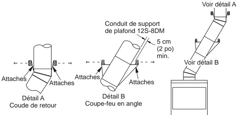
**Figure 10 - Conduit de support de plafond 12S-8DM**
