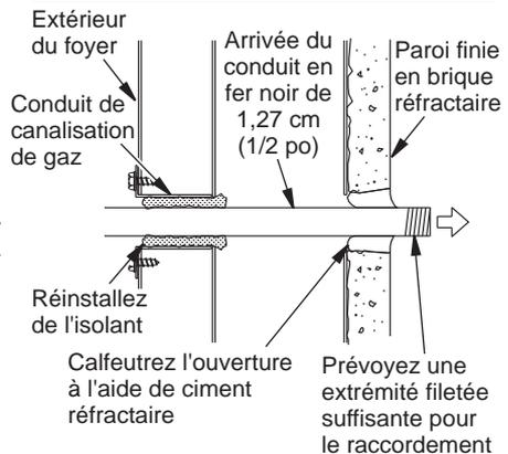
**Figure 22 - Installation de la canalisation de gaz**
