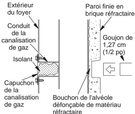
**Figure 21 - Alvéole défonçable de la canalisation de gaz**
