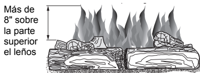
Figura 27 - Patrón incorrecto de la llama del quemador
