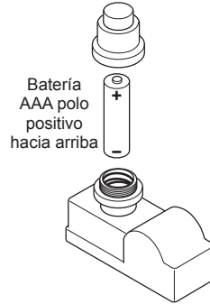
Figura 12 - Instalación de la batería en Ignitor
