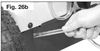
3. Placez l'extrémité du tuyau de solution nettoyante dans un contenant approprié pour vider la solution nettoyante (voir la fig. 27).
