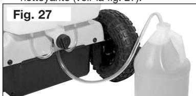
4. Faites tourner le cadran de sélection de détergent en direction du réservoir à vider.
