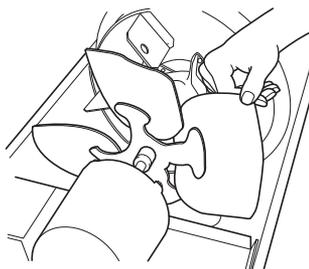
**Figure 13 - Rotation du ventilateur à la main**
