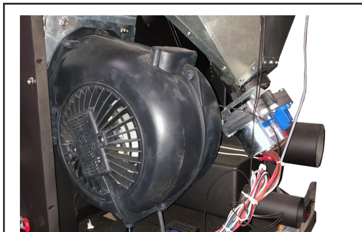
Figure 25 Ventilateur d'échangeur d'air chaud du modèle H3W80XL
