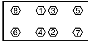
Head Bolt Torque Sequence Séquence De Serrage Des Boulons À Tête Secuencia De Los Pernos Del Cabeza
