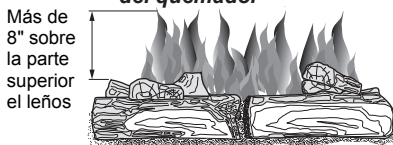
Figura 33 - Patrón incorrecto de la llama del quemador
