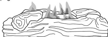
**Figura 44 - Patrón correcto de la llama del quemador**
