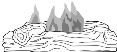
**Figura 45 - Patrón incorrecto de la llama del quemador**
