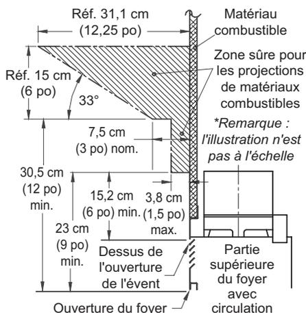
Figure 4 - Dégagements du manteau de foyer par rapport aux matériaux combustibles (avec évent)
