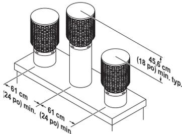
Figure 18 - Installation avec plusieurs enchâssures
