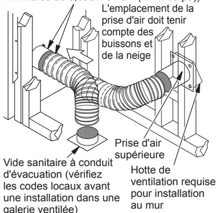
Figure 7 - Prêt-à-monter de gaine d'air extérieur
