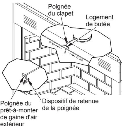
*Figure 24 - Poignets du clapet et du prêt-à-monter de gaine d'air extérieur*
